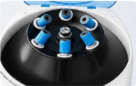
Rotor con los adaptadores puestos. Recién con esta pieza dentro del porta tubos entran los tubos más chicos.
